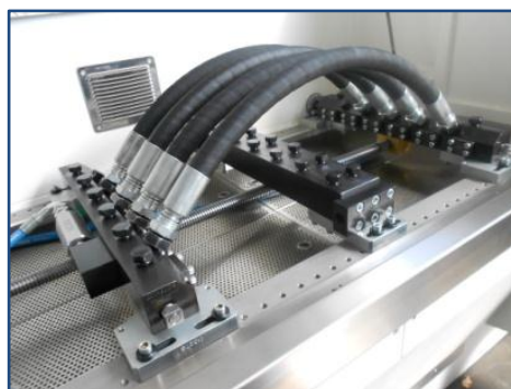
Camera di test con tubi in configurazione di prova
